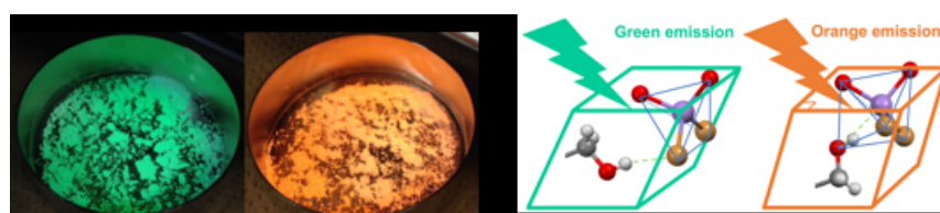
図1 発光ベイポクロミズムを示すマンガン錯体とその構造多形
